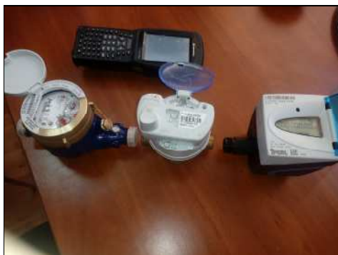
Tipuri de contoare utilizate de S.C. Apa Nova Bucuresti S.A. si Laboratorul S.C. Apa Nova Bucuresti S.A. de verificare metrologica a acestora
